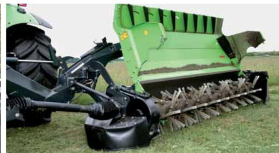
Das gesamte Heck des Mähers kann für einfachen Zugang zum Aufbereiter angehoben werden.
