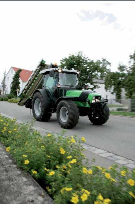
DiscMaster 624T und 628T werden mit Hilfe eines Hydraulikzylinders in eine 125° senkrechte Transportstellung gebracht.
