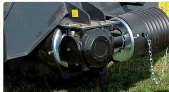
Einstellbare Getriebedrehzahl durch drehen des Getriebes.
