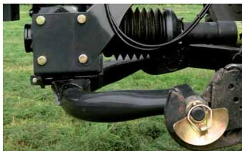
Dank des Schwenkgetriebes sind enge Kurvenfahrten möglich.
