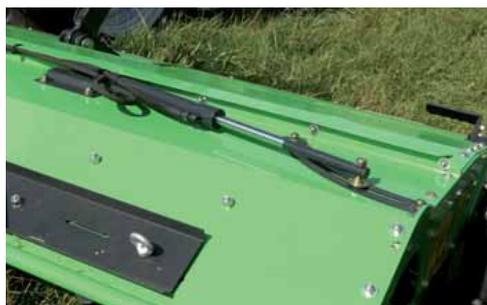
Die gesamte linke Schwadplatte kann hydraulisch von der Schlepperkabine aus bewegt werden (Option).
