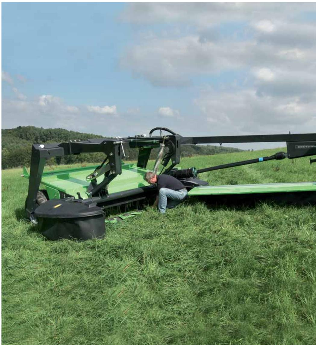
Für die Wartung des Mähbalkens kann die vordere Abdeckung seitlich weggeschwenkt werden.
