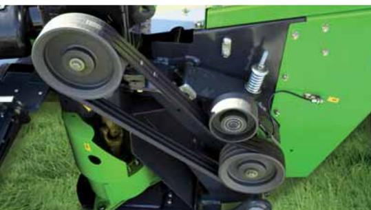
Keilriemenantrieb für Aufbereiterdrehzahlen 600 und 900 U/min.
