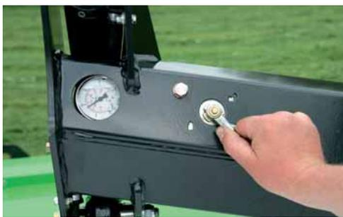
Hydraulische Aufhängung für einfache und präzise Einstellung des Bodendrucks.
