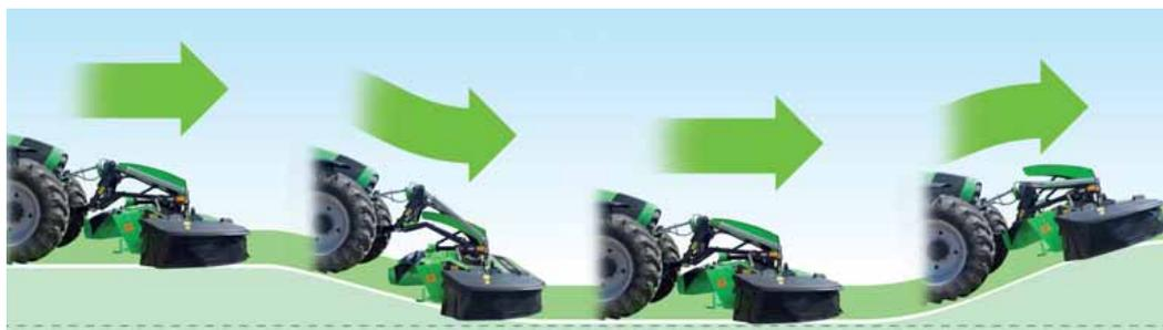
Die Aufhängung der Mäheinheit erlaubt eine Boden Anpassung von 250 mm nach unten und 450 mm nach oben.
