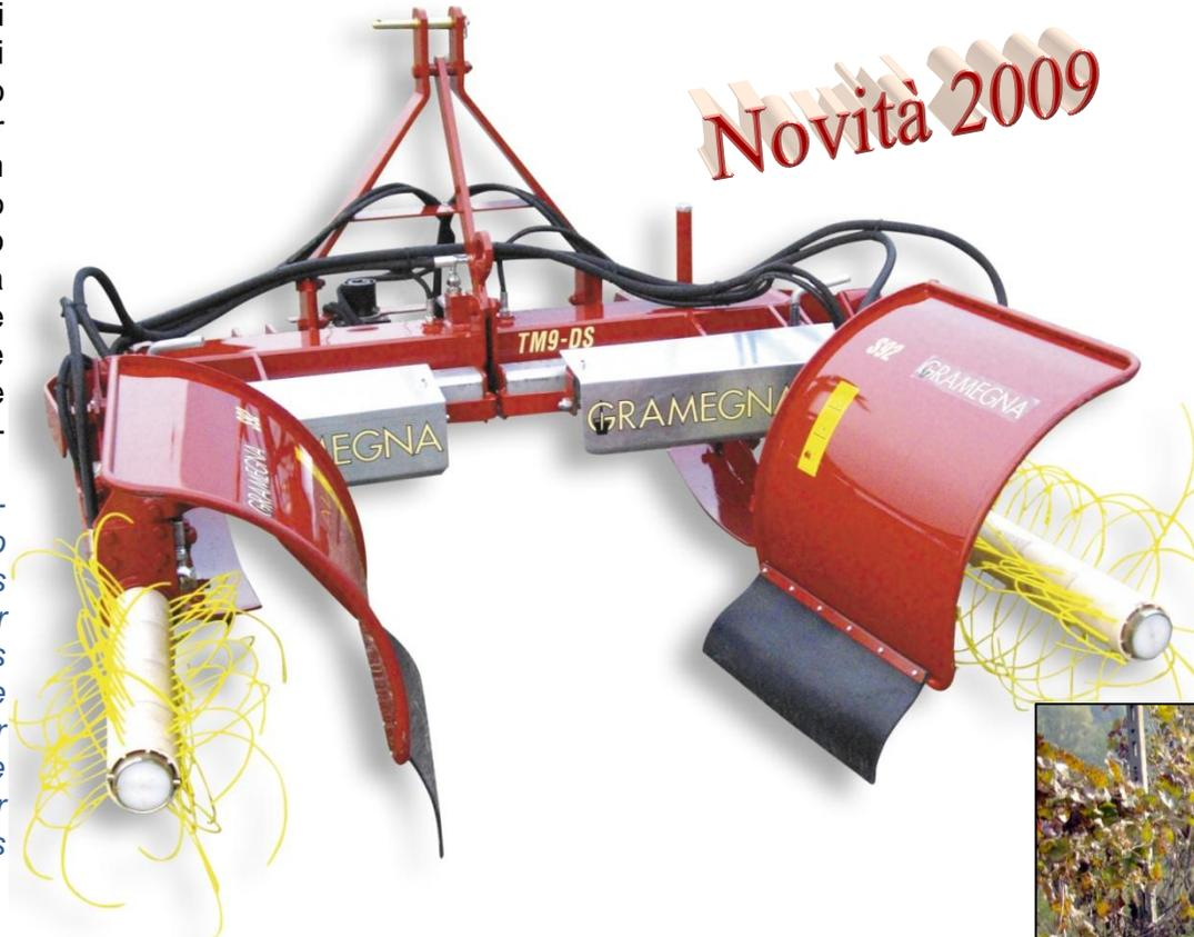
Un ottimo esempio di abbinamento è rappresentato dal TM9 con due spollonatrici-diserbatrici S92: entrambe sono regolabili in altezza dal posto di guida e sono dotate di un sistema rapido per la sostituzione dei fili.
