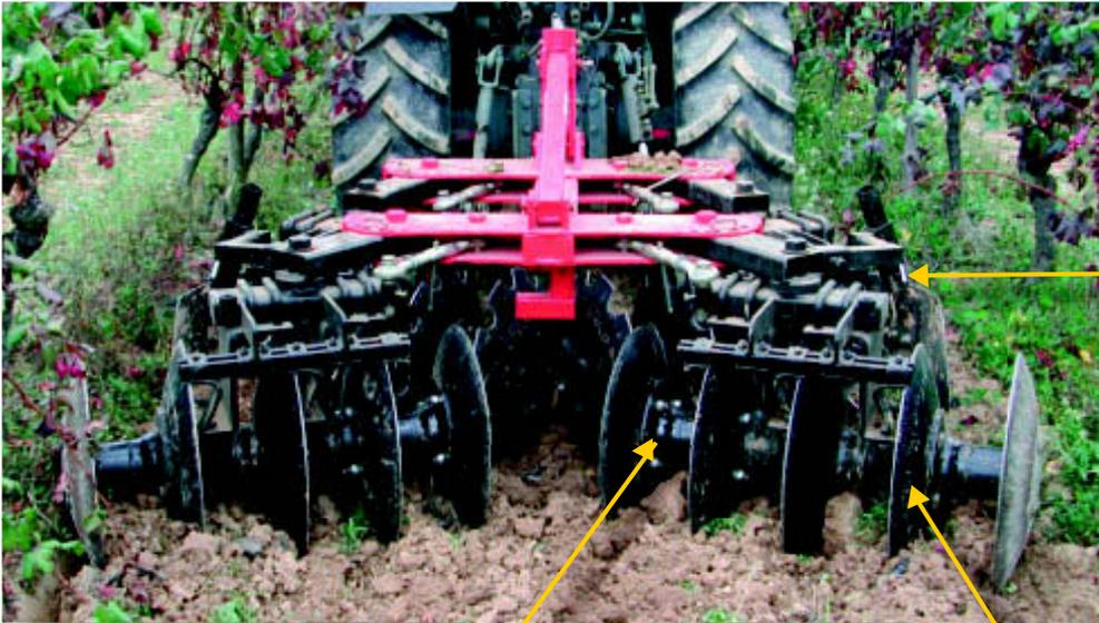
8 paliers avec roulement à billes triple étanchéité
