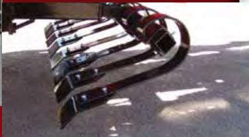
Roues 10x15,10 ply sur 2 demi-essieux carré de 60, 6 axes.- Arbres Ø 70mm en acier permettant au rouleau de travailler dans de bonnes conditions sans risque de flexion.
