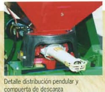
Detalle distribución pendular y compuerta de descarga
