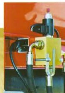
Válvula reguladora y amplificador hidráulico
